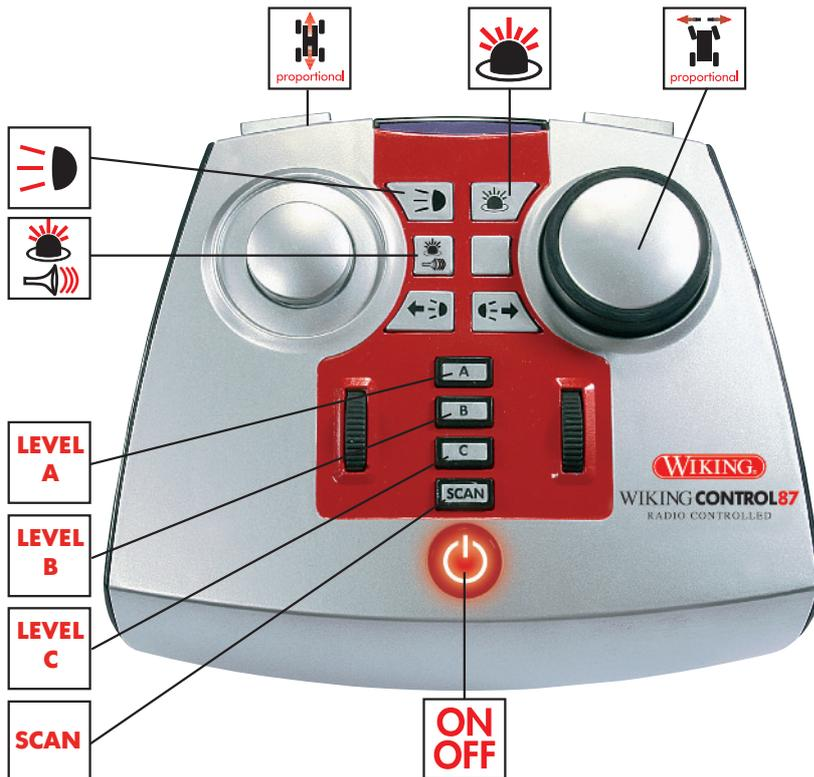
Das WIKING **CONTROL 87**- Funk-Fernsteuermodul ist **identisch** mit dem SIKU **CONTROL 32**- Funk-Fernsteuermodul und kann für beide Systeme genutzt werden.
