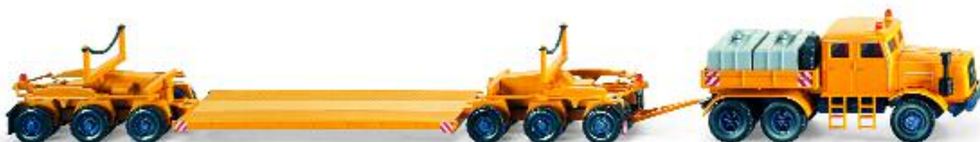
0851 39 48 Scheuerle-Tieflader mit Kaelble Schwerlastpritsche 1950-54
