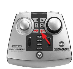
Düz seyir hareketini **↔ ↔** düğmeleri üzerrinden optimum hale getirin. Araç kapatıldığın zaman, değer kaydedilir ve tekrar ayarlanması gerekmek.
