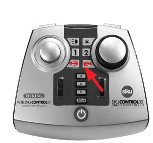
Radioyhteys on muodostettu, kun A-valo palaa.
